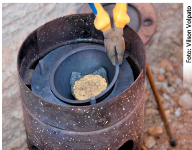
Poluição por mercúrio em garimpo tem como fonte o processo de amalgamação
