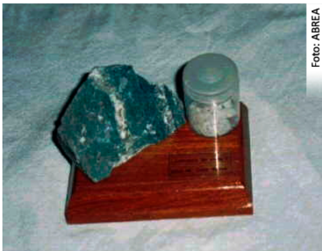
Minério de amianto in natura (à esquerda) e processado (à direita).
